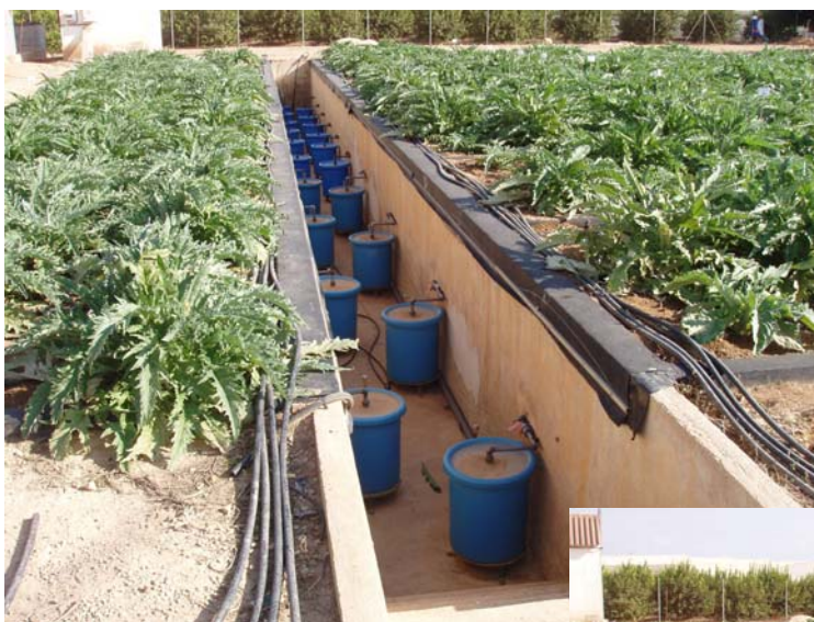
Figura 1. Ensayo de alcachofa en lisímetros de drenaje.
