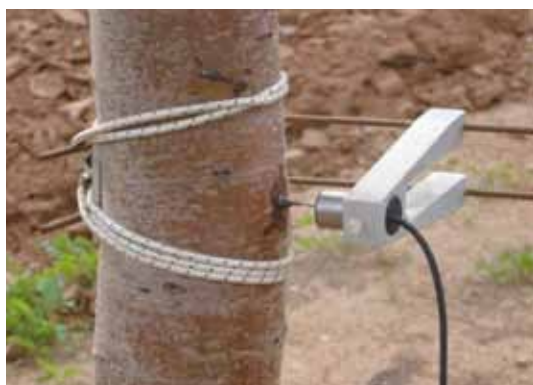
Fig. 5.9a Sensor LVDT y porta-sensor en tronco (Domingo et al., 2005)
