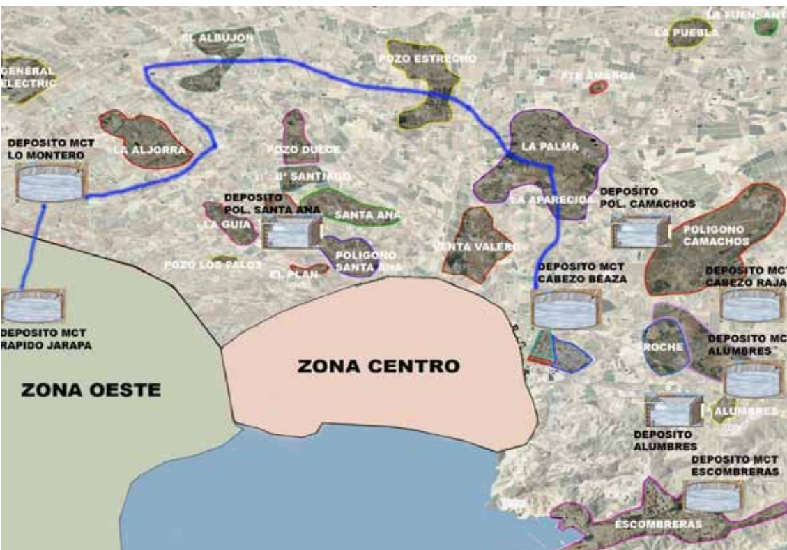
Fig. 3.14 Esquema de la distribuci3n del agua en la Zona Norte
