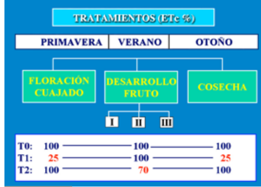
Fig. 5.11b Porcentaje de ETc aplicado y momento de aplicación en cada tratamiento de riego
