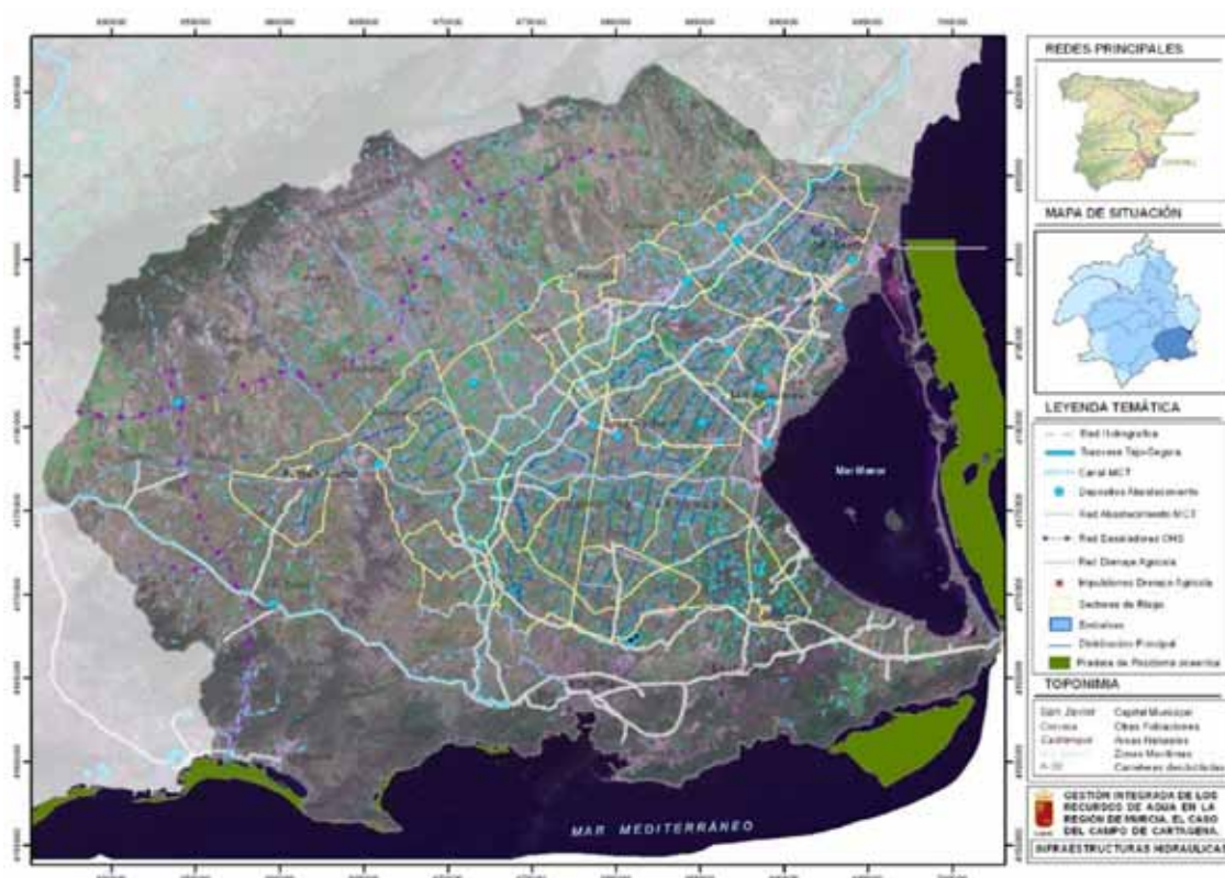
Fig. 3.1 Principales infraestructuras hidráulicas del Campo de Cartagena
