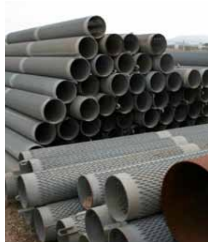
Fig. 3.7 Camisas para el recubrimiento de pozos
